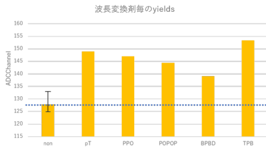
図5 波長変換剤ごとの yield：一番左が何も塗布していない筐体。
