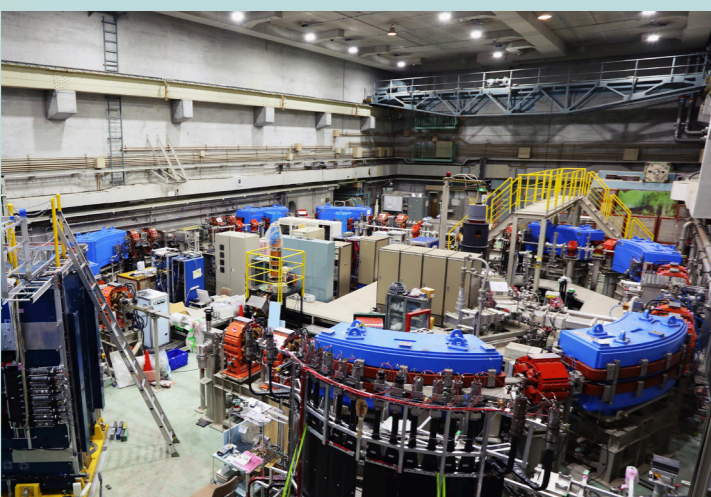
リング入射用電子線形加速器 ブースター・ストレージリングに電子ビームを入射するために建設された電子線形加速器です。最大エネルギー：100MeV
