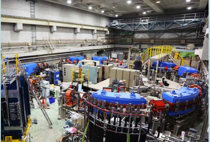
リング入射用電子線形加速器 ブースター・ストレージリングに電子ビームを注入するために建設された電子線形加速器です。最大エネルギー：100MeV
