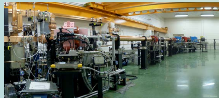
リング入射用電子線形加速器 ブースター・ストレージリングに電子ビームを注入するために建設された電子線形加速器です。最大エネルギー：100MeV
