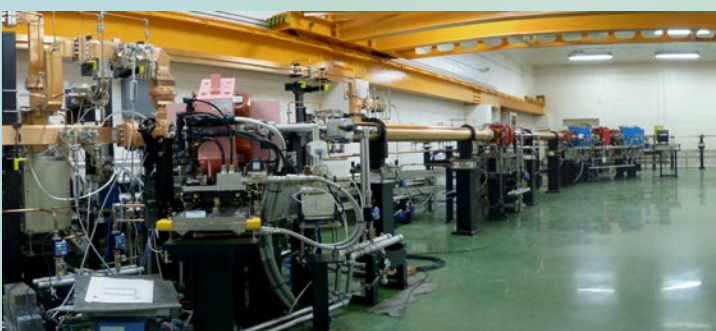
リング入射用電子線形加速器 ブースター・ストレージリングに電子ビームを注入するために建設された電子線形加速器です。最大エネルギー：100MeV
