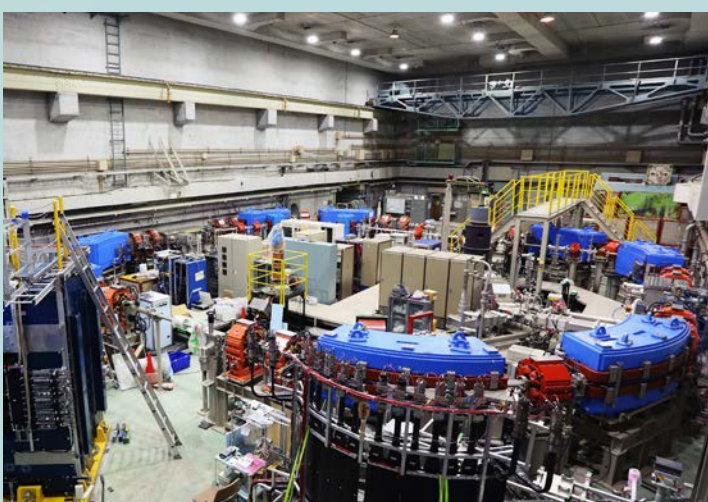
リング入射用電子線形加速器 ブースター・ストレージリングに電子ビームを注入するために建設された電子線形加速器です。最大エネルギー：100MeV
