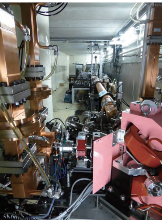
手前左側の高周波電子銃で生成された電子ビームは手前右側のピンク色のα電磁石で偏向され、3m長の加速管で最大50MeVまで加速されます。この小型電子線形加速器を使い、さまざまな加速器・ビーム物理研究が行なわれています。
