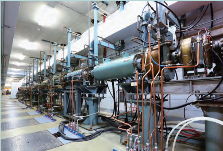
大強度電子線形加速器 1967年に建設された大強度電子加速器です。最大エネルギー：70 MeV、ビーム繰り返し：300Hz、ビームパワー：5kW以上、放射性同位元素（RI）の製造などに利用されています。
