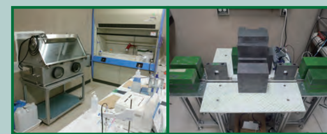
センターには非密封RI約370核種の取扱可能な実験室が設置されています。（左図）試料調製を行う化学実験室、（右図）原子核半減期を測定している装置
