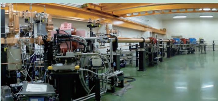
リング入射用電子線形加速器 ブースター・ストレージリングに電子ビームを入射するために建設された電子線形加速器です。最大エネルギー：100MeV
