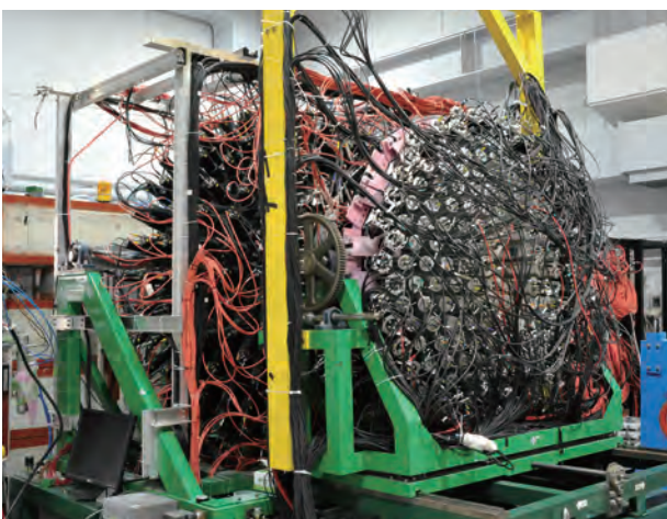
GeV ガンマ線ビームラインにおいてハドロンの多様な状態を生成し、そこから放出される中性パイ(π)中間子やエータ(η)中間子などを捉える実験装置です。CsI結晶、鉛・シンチレーティングファイバー、鉛ガラスの3つのガンマ線検出器から構成されています。
