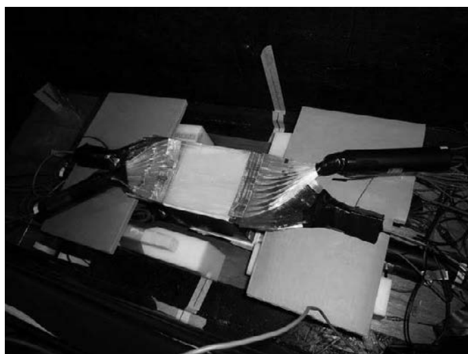
第7図 端面に光電子増倍管を接続したファイバーシートで検出器の壁面を覆っている。
