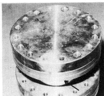
(b) 2分間のビーム照射後のステンレス鋼の表面が高温になり焼けた様子。熱電対はビームスポットに最も近いボルトと下側フランジのすきまに取付けた(矢印)。
